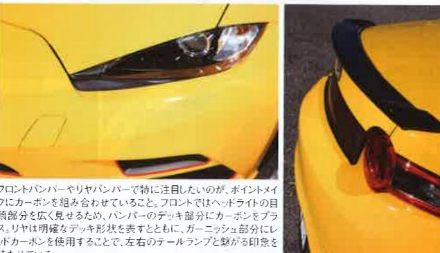
左右のフロントダクトが存在感を主張するフロントバンパー。ダクトフィンが中央でつながるようにデザインされた造形はスポーツカーらしい印象を与える。また、ヘッドライト部分は中央部分が細く絞り込まれ過ぎていると考え、あえて目頭部分をフラットにしているのも特徴のひとつだ。
